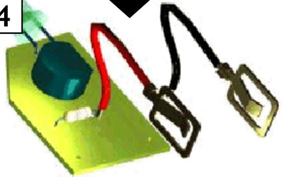
Prendre l'extrémité dénudée du fil noir et venir la mettre sur le circuit imprimé
