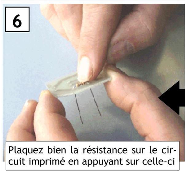
Plaquez bien la résistance sur le circuit imprimé en appuyant sur celle-ci
