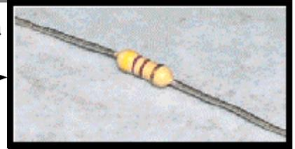
Positionnez la résistance dans les encoches du plieur
